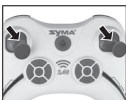
Калибровка гироскопов: если квадрокоптер стремится улететь в каком-либо направлении в каждом полёте, выполните калибровку. При выключенном передатчике и включённой модели установите ручки в положение, указанное на рисунке, не отпуская ручки включите передатчик, через 3 секунды установите ручки в нейтральное положение.
