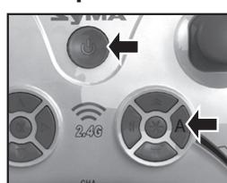
Переключение раскладки (Mode 1 или Mode 2): при выключенном передатчике нажмите и удерживайте кнопку A, не отпуская кнопку включите передатчик, отпустите кнопку.
