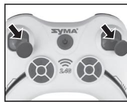
Калибровка гироскопов: если квадрокоптер стремится улететь в каком-либо направлении в каждом полёте, выполните калибровку. При выключенном передатчике и включённой модели установите ручки в положение, указанное на рисунке, не отпуская ручки включите передатчик, через 3 секунды установите ручки в нейтральное положение.
