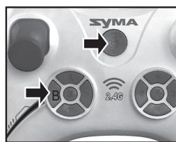
Быстрый сброс триммеров: при выключенном передатчике нажмите и удерживайте кнопку B, не отпуская кнопку включите передатчик, отпустите кнопку.
